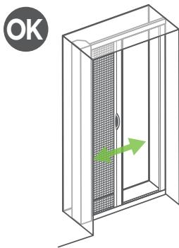
Présenter les trois montants à la maçonnerie, tracer les trous de fixation à l'aide d'un crayon.
