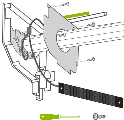
Mettre en place le coffre bas **C** et le fixer à l'aide des vis.
