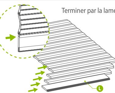
Enrouler le tablier dans le sens de la courbure.
