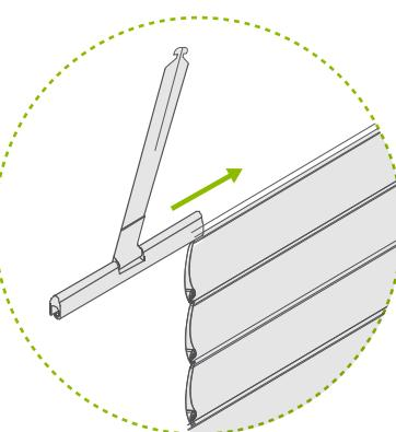
Fixer le tablier en insérant les attaches lames dans les fentes du tube prévues à cet effet.
