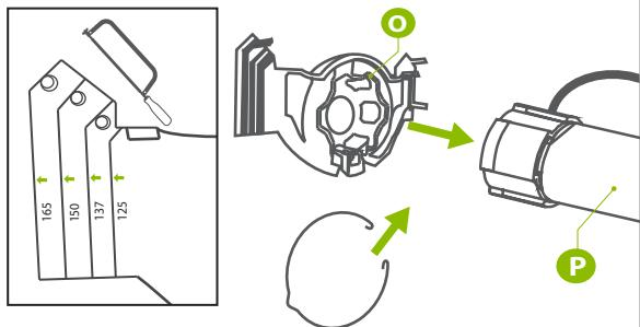
Utiliser le circlips pour fixer le support au moteur.
