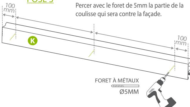
Retourner les coulisses et percer la première épaisseur avec un foret de 10mm afin de permettre le passage de la tête de vis lors de la fixation à la maçonnerie.
