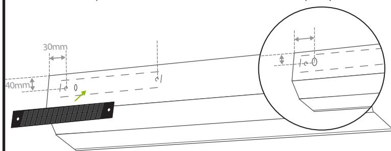
Utiliser une pince à rivet pour fixer le panneau sur le coffre.
