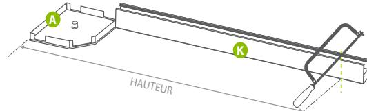
POSE 3 : Scier les coulisses à la hauteur relevée lors de la prise de mesures.
