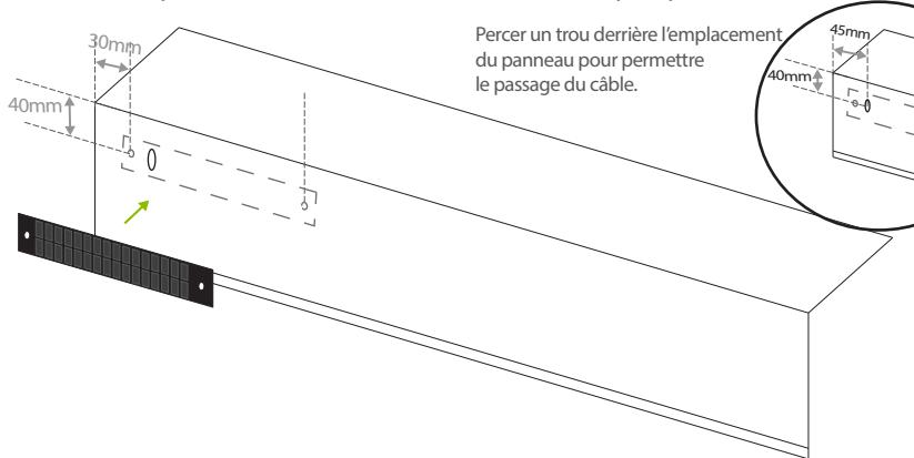
Utiliser une pince à rivet pour fixer le panneau sur le coffre.
