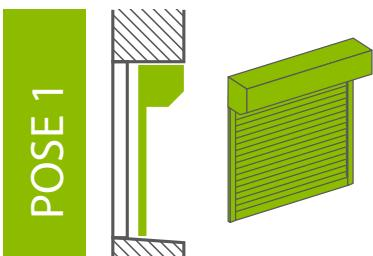
Présenter l'ensemble joue et coulisse à la maçonnerie, tracer les trous de fixation de la coulisse à l'aide d'un crayon. Retirer la coulisse, percer et insérer les chevilles.
